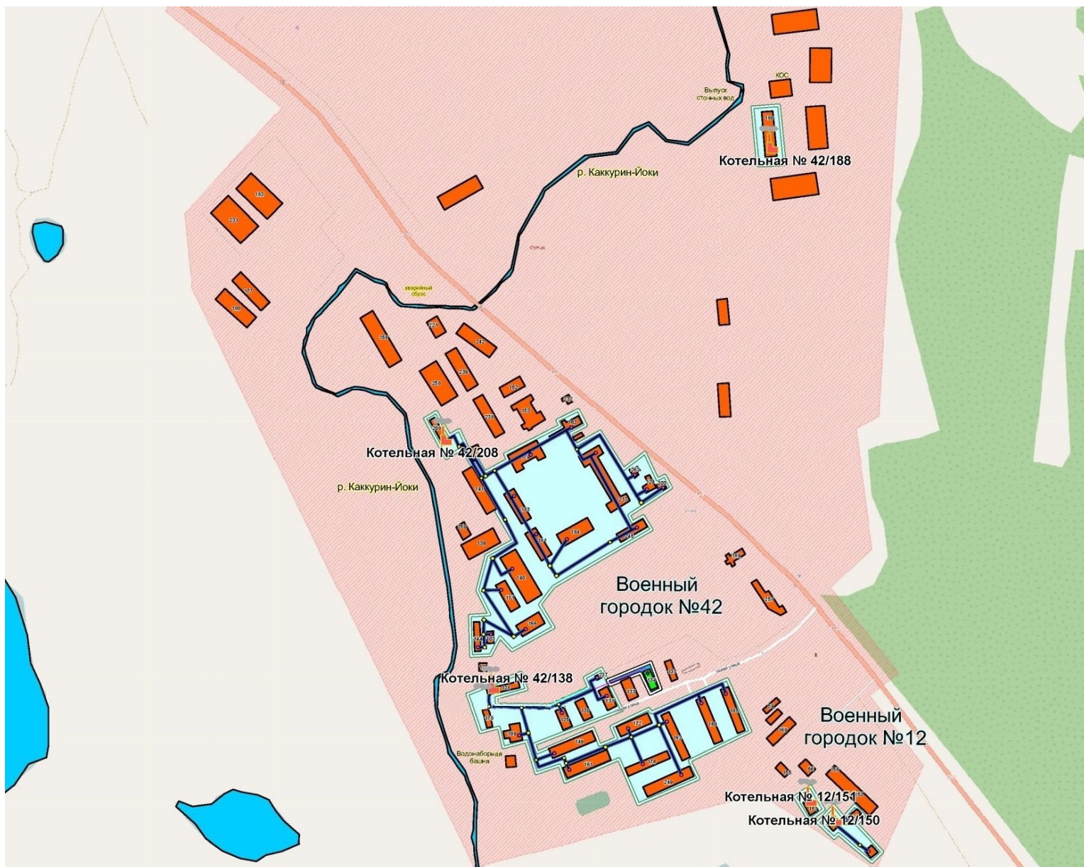
Рисунок 1.11 1 – Зоны действия котельных на территории н.п. Спутник
